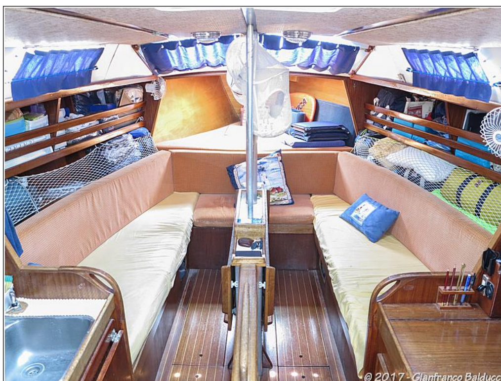
La cabina principale; notare la cassa della deriva al centro, ed il "letto bretone" a prua. Sotto le cuccette, i serbatoi dell'acqua ed ampi spazi di stivaggio. Sotto il pagliolo, la zavorra.
