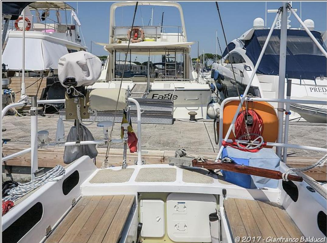
Il pulpito di poppa che porta il supporto per il motore fuoribordo, le antenne GPS, Navtex e TV, il rullo con la cima di poppa, il salvagente a ferro di cavallo con cima galleggiante e boetta luminosa automatica. Visibile anche il gavone stagno per la bombola del gas.
