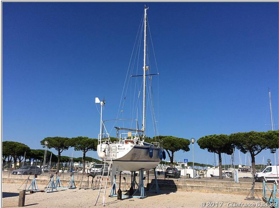
Lo scafo è in lega di alluminio (serie 5086), a spigolo nella parte immersa ed arrotondato nella parte emersa. La deriva e la parte inferiore del timone possono ruotare all'indietro, permettendo di ridurre il pescaggio quando si manovra in acque poco profonde come pure di far posare lo scafo sul fondale in bassa marea.
