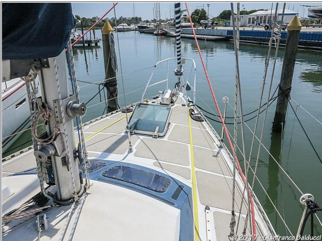
A prua, un verricello elettrico (comandabile anche dal pozzetto) installato sopra il gavone per la catena dell'ancora. Il musone di prua porta due rulli e quattro galloce.
