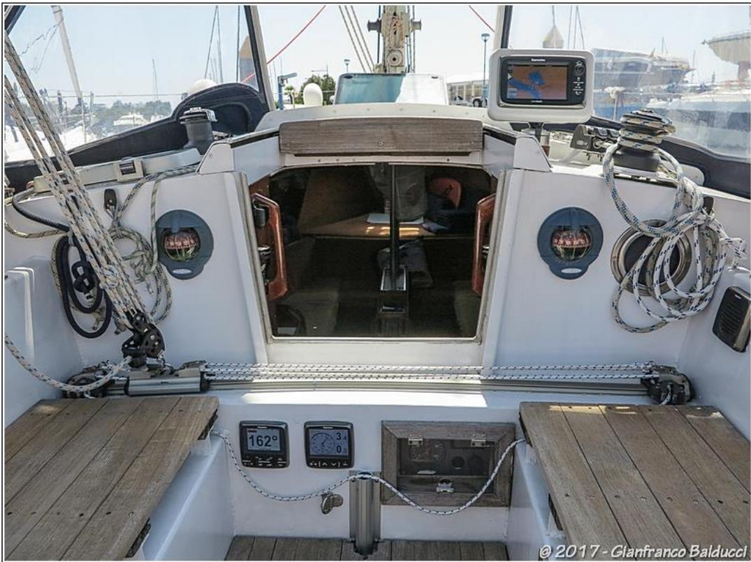
In pozzetto due bussole di rotta, il display del radar/chartplotter, il quadro del motore ed i due display multifunzione log/scandaglio/vento ed autopilota. L'autopilota può anche essere comandato tramite un telecomando wireless.
