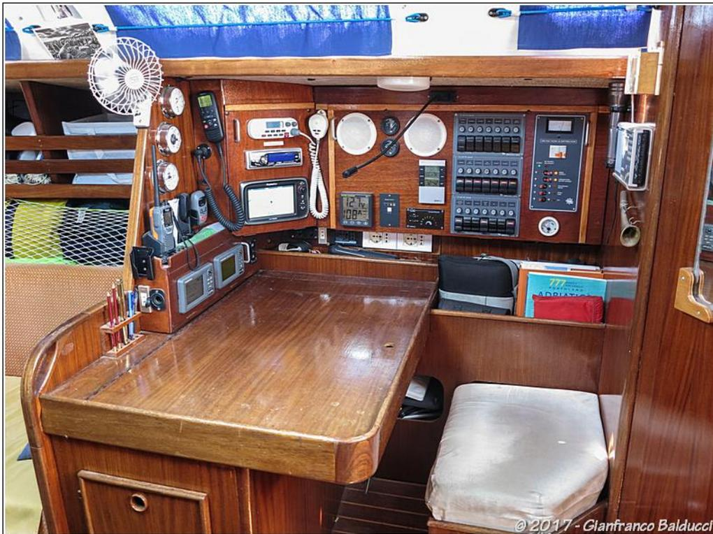
La zona carteggio, i quadri elettrici 12V e 220V, il monitor batterie, il display radar/chartplotter, 2 radio VHF fisse, radio VHF palmare, ricevitore GPS di riserva, ricevitore Navtex, autoradio, spazi di stivaggio per carte nautiche e pilot books.
